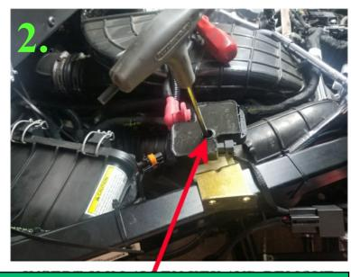
INSERT 5MM ALLEN KEY AND REMOVE 10MM NUT ON THE OTHER SIDE. INSTALL RELAY GROUND. REINSTALL 10MM NUT
