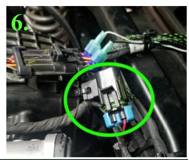
RUN WIRING DOWN INTAKE PIPE USING FACTORY WIRE HOLDERS AND ROUTE AROUND THROTTLE
